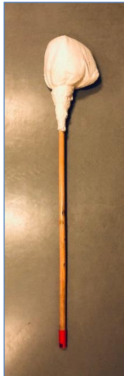
Figura 1: Supporto creato per la pulizia del gantry RM compatibile
